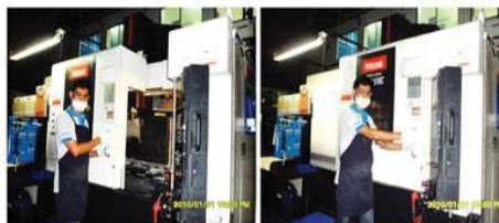
1. ตัวควบคุมการล็อคของประตูด้านหน้าบริเวณที่ขึ้นปฏิบัติงาน (Operator's door interlock)
